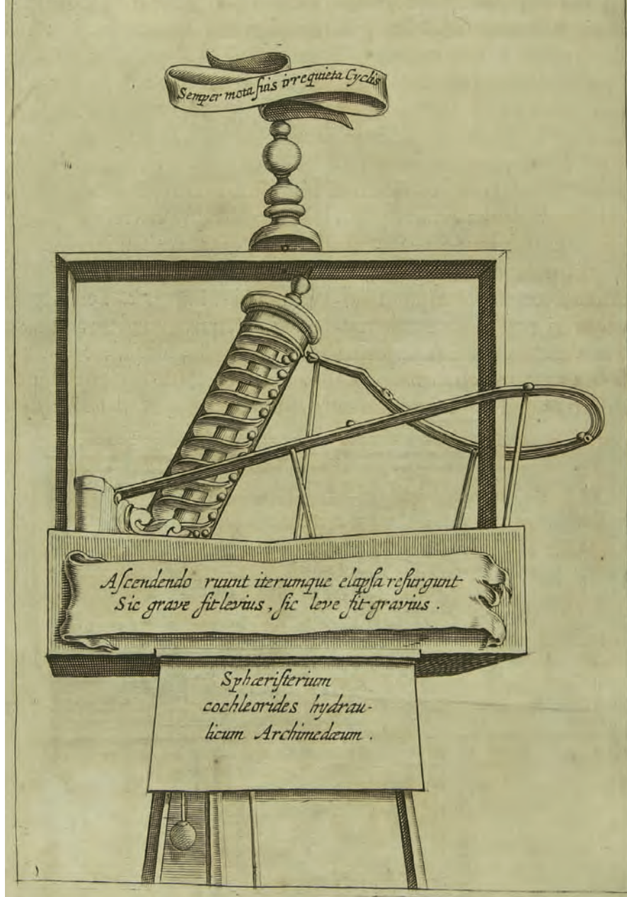
Hydraulische Demonstration mit archimedischer Schraube.
