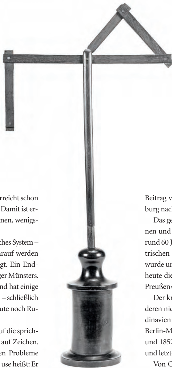
Um 1800 entstand das Modell eines optischen Telegrafen nach Chappe, das im Deutschen Museum gezeigt wird.
